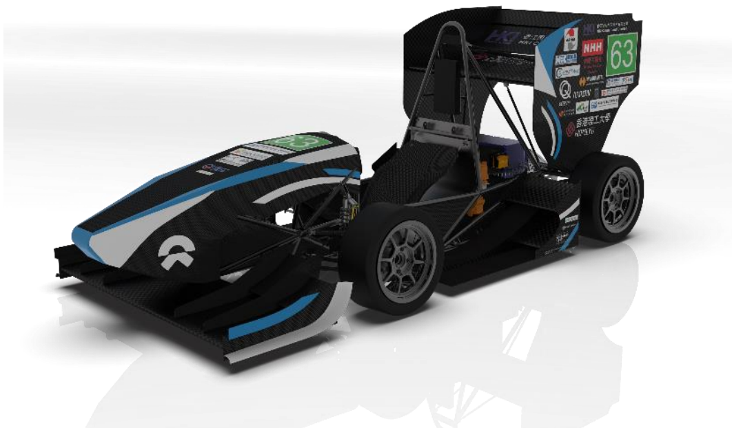
香港理工大學電動方程式車隊展示其自行設計及組裝的電動方程式賽車
